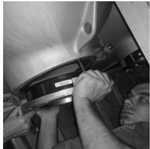
Slika 9. Zamena pucajućeg diska
