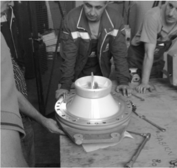
Slika 6. Provodni izolator između gasnih zona G0 i G1
