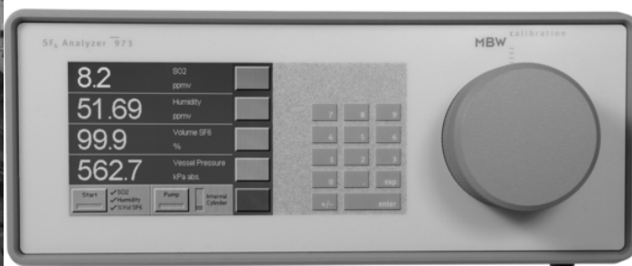
Slika 5. Uređaj za ispitivanje kvaliteta SF6 gasa
